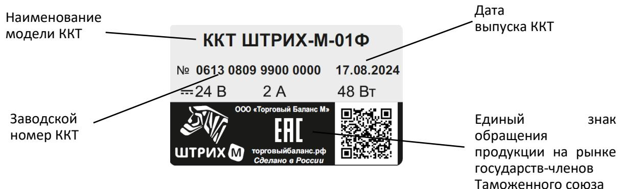
Корпус ККТ обеспечивает возможность опломбирования ККТ в условиях предприятия-изготовителя. Место пломбирования – по ГОСТ 18680-73. Пломбировка находится на стыке корпуса и/или на нижней его части в месте, исключающем вскрытия ККТ без нарушения наклейки. Место установки заводской наклейки и её вид приведены ниже:
